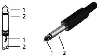
Eine 6,35-mm-Klinkenbuchse (mono) dient als Signalausgang am Empfänger. Zeichnung und Tabelle zeigen die Belegung des passenden Steckers.
